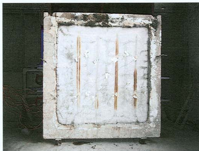
Fotografia della faccia non esposta al fuoco del campione dopo la prova.
